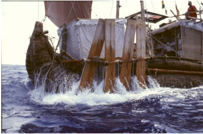
Abb. 3: Die Seitenschwerter haben erst die ABORA II zu dem gemacht, was sie ist: Ein voll manövrierfähiges Schiff, das bis 70° gegen den Wind kreuzen konnte.
