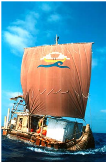
Abb. 2: ABORA II unter vollen Segeln auf Gegenwindkurs. Bei Windstärken um 3-4 erreichte das Binsenschiff im Mittel eine Geschwindigkeit von 1.5 – 2 kn, wobei sie am Tag etwa 60 – 100 km zurücklegte.
